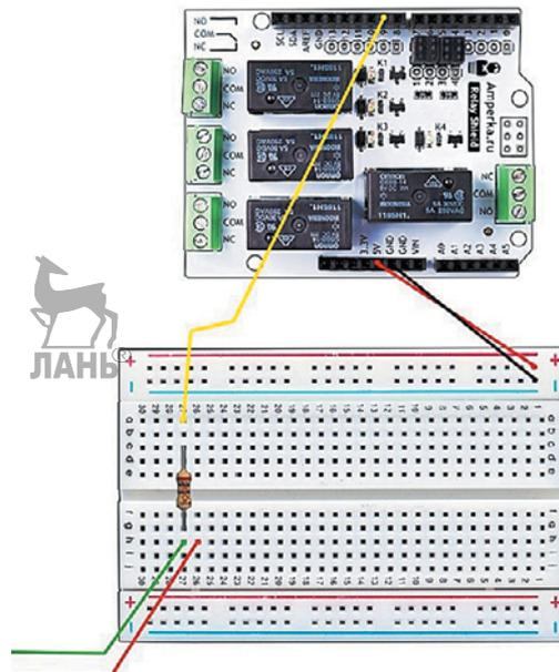
6. Подведи к светодиоду землю. Для этого чёрным проводом «папа-папа» соедини **пятый пин снизу** шины «-» на макетной плате и **пин g26** макетной платы.
