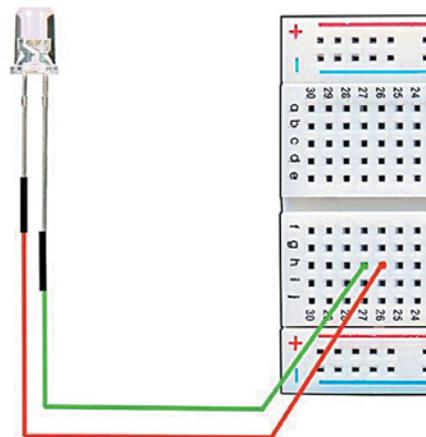
4. Подключать светодиод напрямую к шине питания 5 V нельзя! Возьми резистор на 220 Ом. Он позволит выровнять (снизить) нагрузку, чтобы не повредить светодиод. Подогни **ножки резистора** и подключи их к **пинам g27 и c27** макетной платы.
