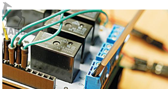
2. Разрежь одну жилу двухжильного провода, который идёт к патрону для лампы. Они равноценные, поэтому не имеет значения, какой из двух ты выберешь. На месте разреза будет крепиться устройство, поэтому выбирай такое место разреза, чтобы потом тебе было удобно. Arduino будет управлять замыканием контакта, т. е. обеспечивать подачу питания на лампу. Нетронутая жила отвечает за заземление (GND).
