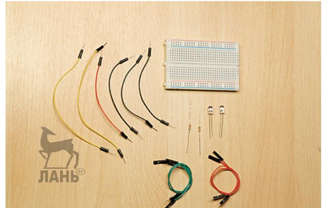
Теперь рассмотрим макетную плату BreadBoard Half. На ней нанесены буквы, числа, вертикальные линии, знаки «+» и «-» — все они являются обозначениями различных шин. Макетная плата позволяет соединять одновременно несколько компонентов без пайки.
