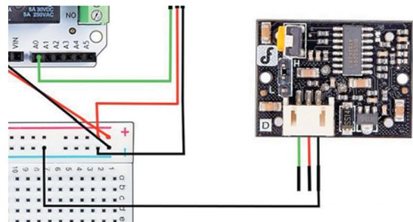
3. **Красным проводом** «папа-папа» соедини **красный провод** шлейфа и **шестой пин** на шине питания («+») макетной платы.
