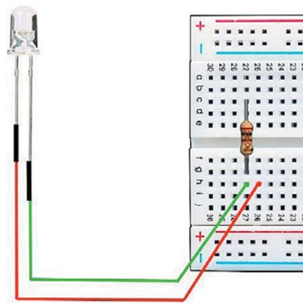
В отличие от шины «+», питание на светодиод будет подаваться не постоянно, а согласно значению 0 или 1 в программе, т. е. питание управляемо с помощью сигнала контроллера. Сигнал принято обозначать латинской буквой «S» (от английского *Signal*) и использовать для него жёлтый цвет.
