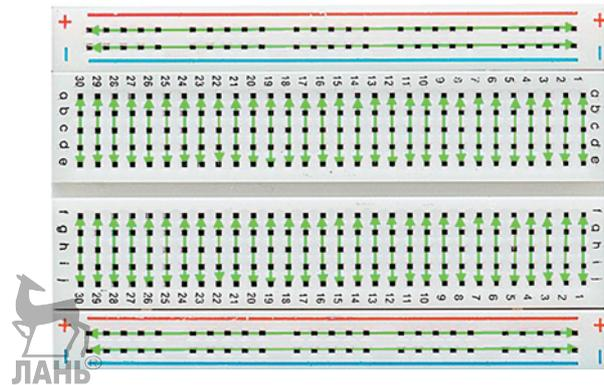
**Важно!** На рисунке обозначены различные шины макетной платы. Боковые шины соединены продольно, средние — поперечно.
