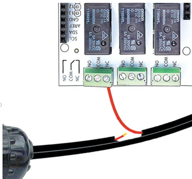
\* NC (normally closed) — нормально замкнутый контакт. В рабочем состоянии имеет замкнутый контакт.
