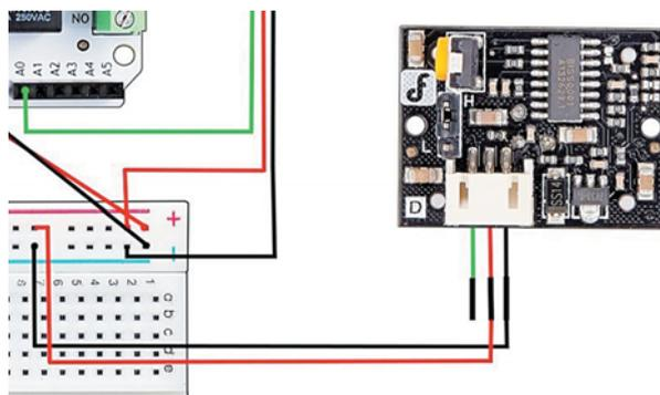
4. **Зелёным проводом** «папа-папа» соедини **зелёный провод** шлейфа и цифровой пин № 12 (**Digital 12**) на плате Relay Shield.
