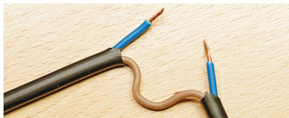
4. Конец части обрезанного провода, которая идёт к вилке, помести в клемму с надписью NC\*. Крепко затяни клемму. Внутри клемм должны оказаться только медные концы проводов без изоляции (оболочки). Если длины оголённой части проводов недостаточно, попроси взрослых снять нужное количество изоляции. Если провод на конце «распушился», закрути его.
