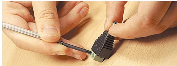
2. Помести конец чёрного провода в гнездо со знаком «минус», а красного — в гнездо со знаком «плюс». Внутри клеммника должны оказаться только медные концы проводов без изоляции (оболочки). Если длины оголённой части проводов недостаточно, попроси взрослых снять нужное количество изоляции. Если провод на конце «распушился», закрути его.
