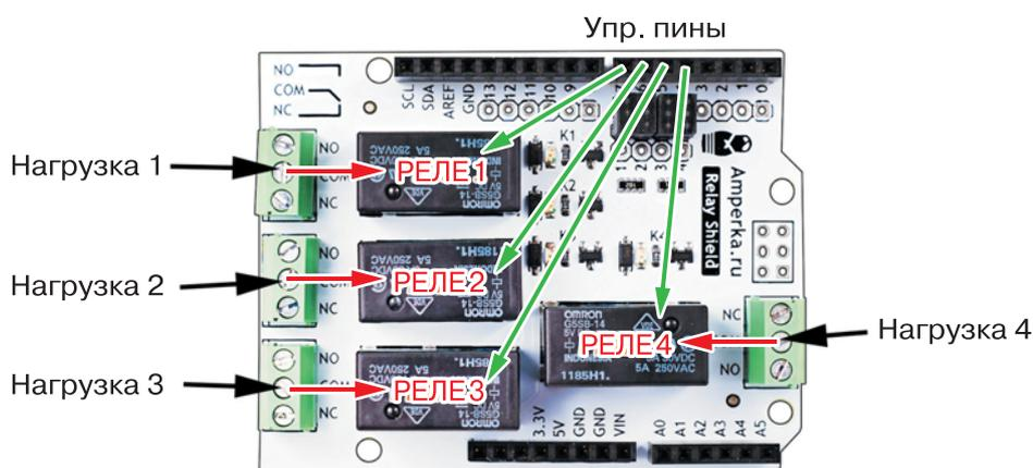
В проекте для управления уже используется **цифровой выход № 7 (Digital 7)**. Он отвечает за управление первой нагрузкой, т. е. первым реле. За остальные три нагрузки отвечают **цифровые выходы № 6, 5 и 4 (Digital 6, Digital 5 и Digital 4)**. Концы обрезанных проводов по направлению к источнику питания (вилке) должны быть помещены в клемму **NC**, а концы проводов, идущих к лампочкам, в клемму **NO**.
