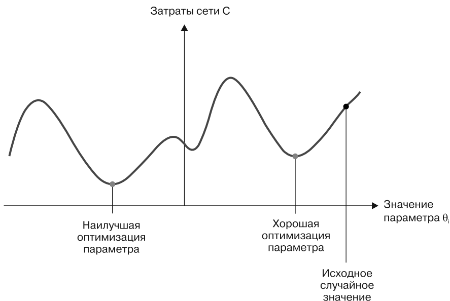
Рис. 3.8. При использовании градиентного спуска производится коррекция параметров сети для минимизации штрафа (потерь) на этапе обучения
