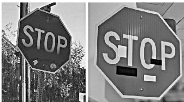
Рис. 1.8. Физическое искажение знака остановки может обмануть автономное транспортное средство, использующее видеоданные (изображение из статьи Эйкхолта и др. от 2018 года)
