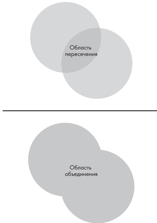
Рис. 2.6. Пересечение относительно объединения для множества — это область пересечения, поделенная на область объединения
