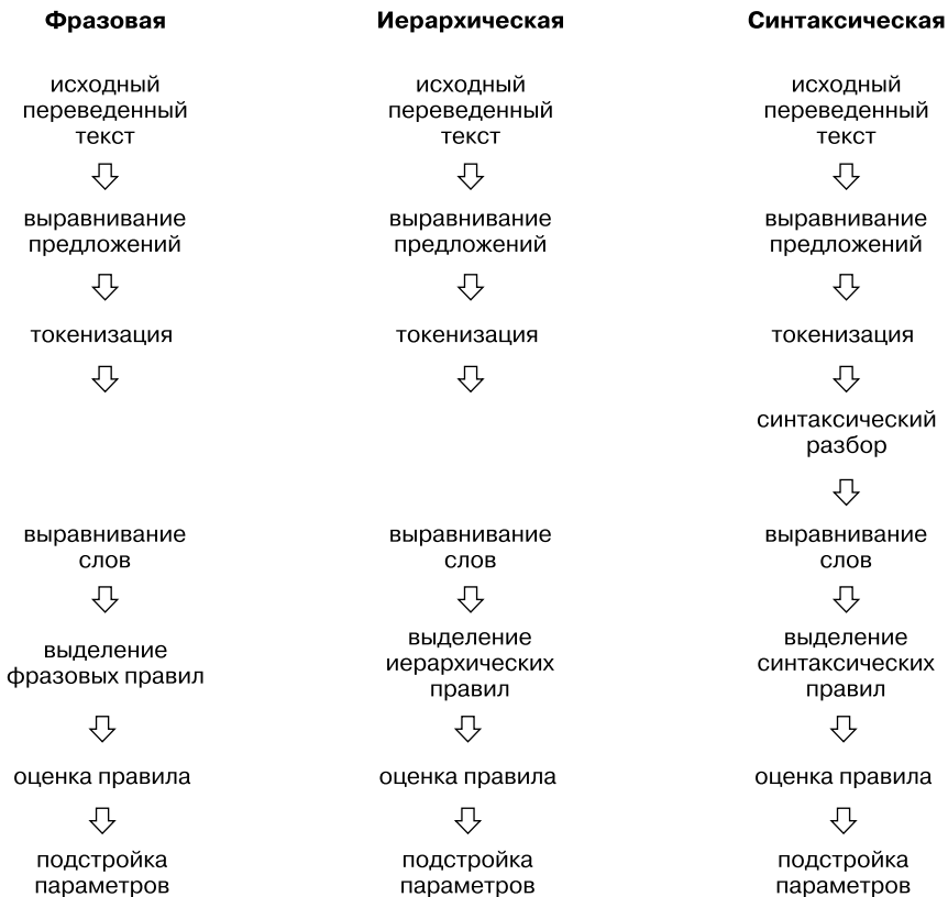
Рис. 9.6. Конвейеры обучения традиционных систем машинного перевода рассматривают задачу как последовательность подзадач, каждую со своей моделью. Сравните это с моделью нейронного машинного перевода, обсуждавшейся в разделе «Пример: нейронный машинный перевод» на с. 215 (рисунок любезно предоставлен Х. Хоангом [Hoang et al., 2009])
