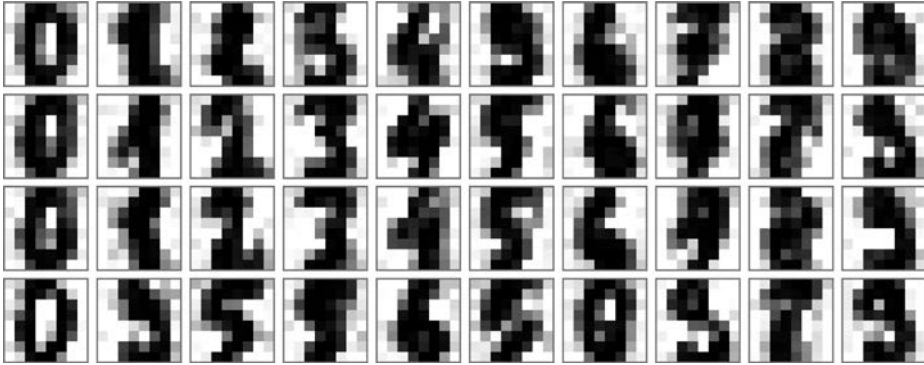
Рис. 45.11. Цифры после устранения шума с помощью метода PCA
