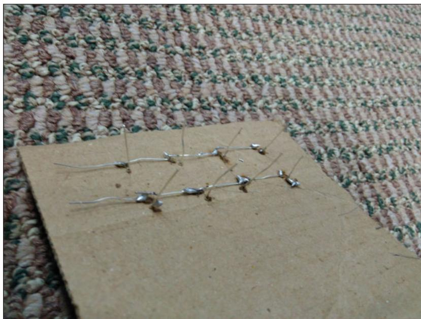
На предыдущем изображении отображаются только два ряда слоев. Если вы работаете с медными светодиодными кабелями, вы должны знать, что конструкции, созданные с использованием медных кабелей, не будут такими прочными. Чтобы усилить жесткость слоя, отрежьте и припаяйте два прямых отрезка проволоки с обоих концов. Убедитесь, что они соединяются с каждым рядом. Вот и все. Ваш первый слой готов.
