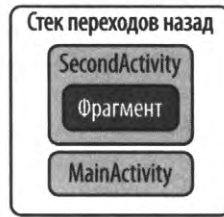
Рис. 3.5. Транзакция экземпляра Fragment в стеке переходов назад будет отменена до того, как содержащая его активность будет извлечена
