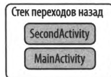
Рис. 3.4. В стеке переходов назад страницы Activity хранятся согласно принципу "последним пришел — первым ушел" (LIFO)
