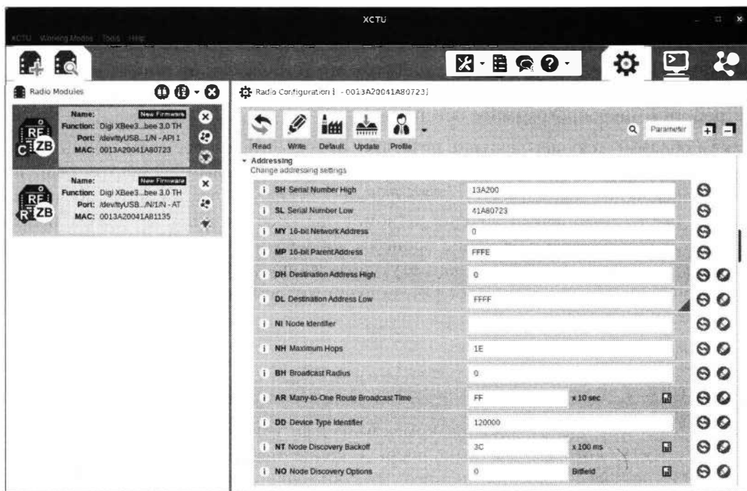
Рис. 14.5. Поиск старшей и младшей частей серийного номера радиомодуля XBee в приложении XCTU
