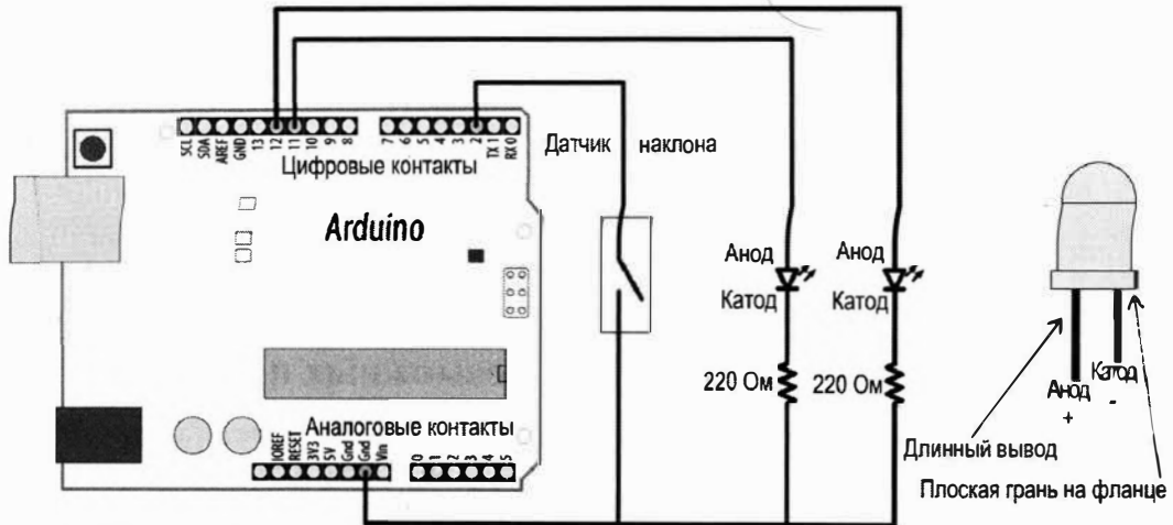
Рис. 6.1. Подключение к плате Arduino датчика наклона и двух светодиодов
