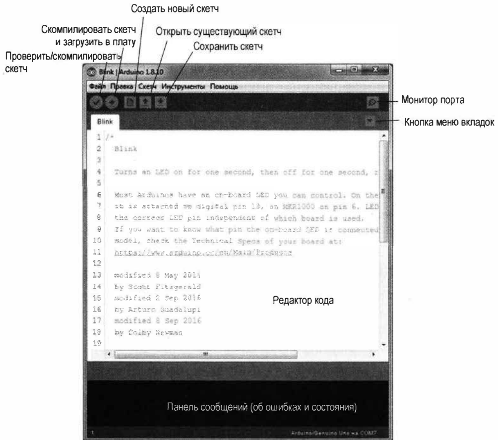
Рис. 1.5. Элементы панели инструментов и окна среды Arduino IDE
