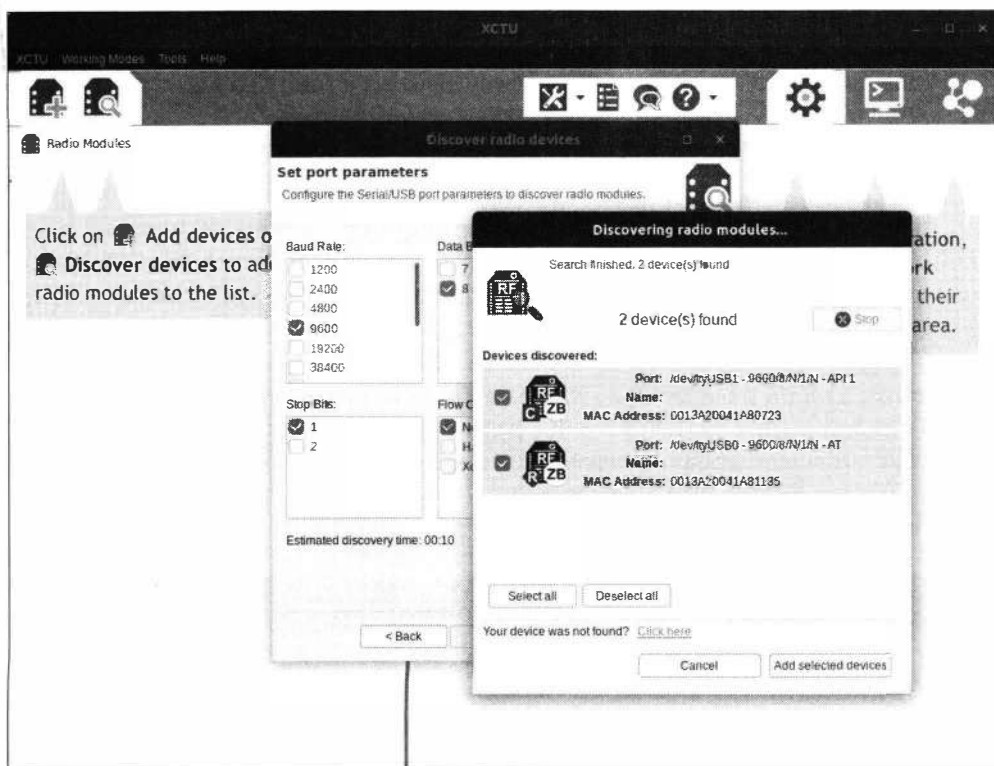
Рис. 14.3. Обнаружение программой XCTU радиомодулей XBee, подключенных к компьютеру
