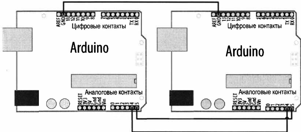
Рис. 13.11. Подключение двух плат Arduino по протоколу I 2 C: одна плата — ведущая, а другая — ведомая
