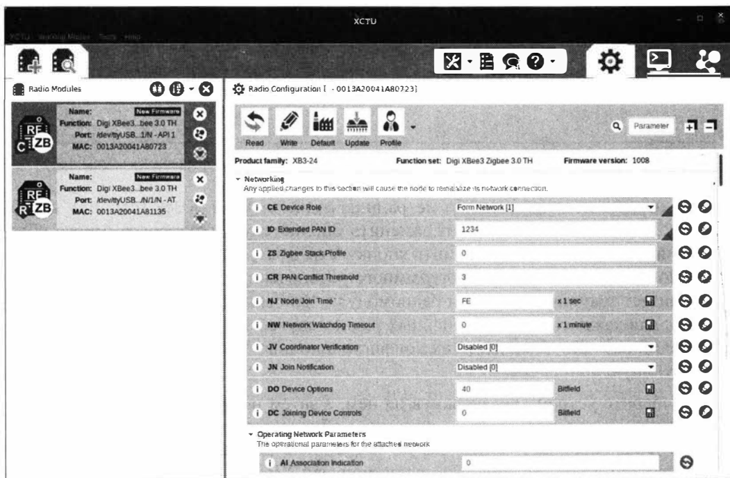
Рис. 14.4. Индивидуальное конфигурирование радиомодулей XBee
