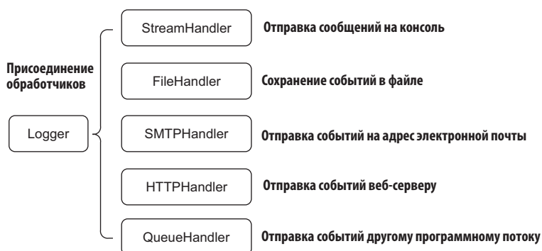
Рис. 12.1. К регистратору присоединяются различные обработчики. После создания регистратора можно инстанцировать несколько обработчиков и присоединить их к регистратору. Каждый из них будет предназначен для соответствующей цели
