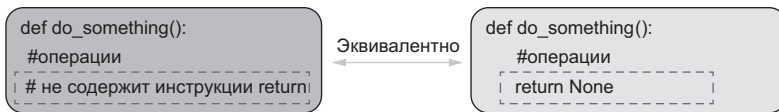
Рис. 6.2. Неявное возвращение значения функцией. Если функция не содержит инструкции return , это эквивалентно тому, что функция возвращает None
