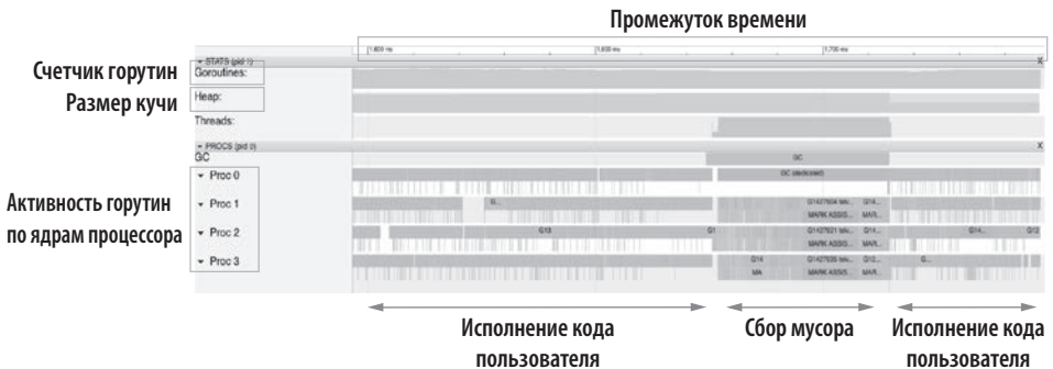
Рис. 12.39. Отображение активности горутин и событий во время выполнения приложения (например, фаза сборки мусора)
