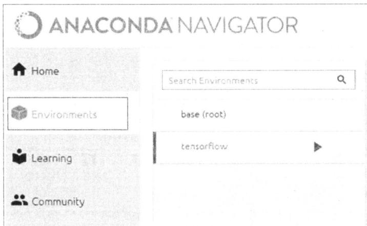
РИС. 1.3. Для того чтобы создать новую среду, сначала необходимо перейти в раздел **Environments** приложения, щелкнув по соответствующей ссылке на левой навигационной панели (обозначена на рисунке кубиком)
