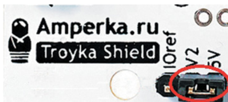
Рис. 4.88. Перемычка соединяет V2 и 5V
