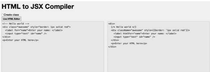
Рис. 5.3. Инструмент преобразования HTML в JSX
