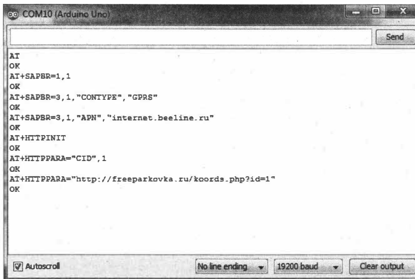
Рис. 3.34. Отправка AT-команд на GSM/GPRS Shield SIM900 из последовательного порта
