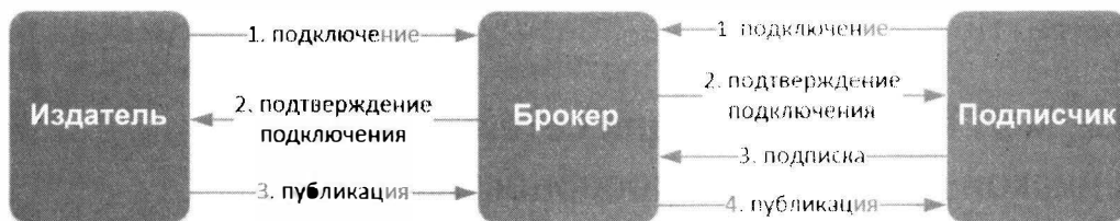
Рис. 4.1. Схема взаимодействия по протоколу MQTT
