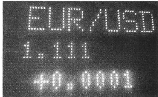
Рис. 6.18. Вывод на RGB-матрицу 64×32 текущих котировок EUR/USD
