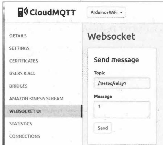
Рис. 4.6. Отправка команд управления из профиля cloudmqtt.com
