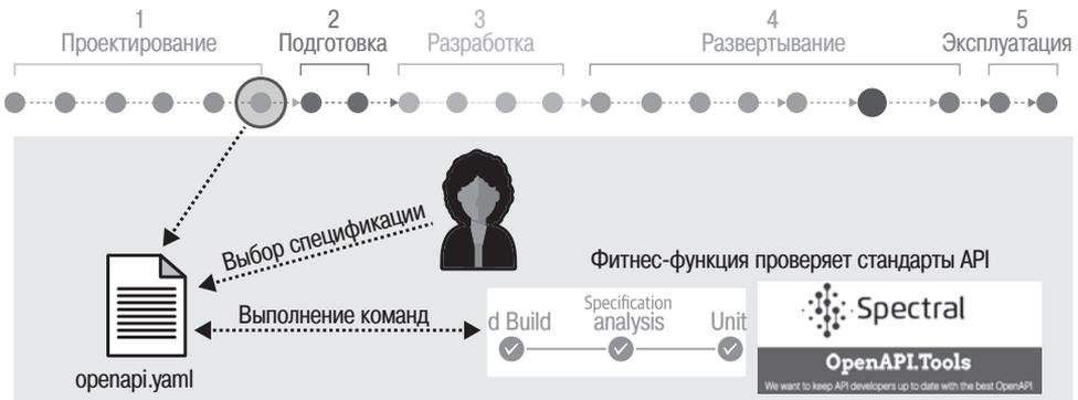
**Рис. 3.8.** Фитнес-функция согласованности как часть пайплайна развертывания
