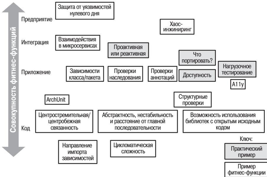
Рис. 4.1. Обзор фитнес-функций
