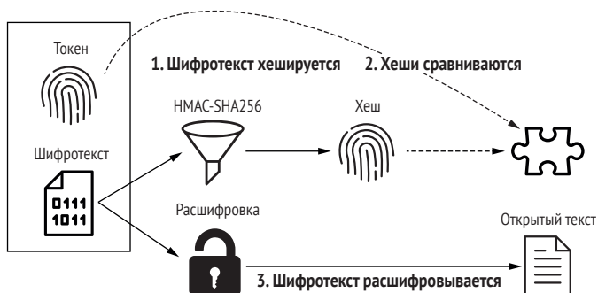
Рис. 4.3 Fernet проверяет подлинность шифротекста и только потом расшифровывает его
