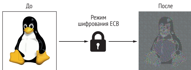
Рис. 4.5 При использовании режима ECB структура открытого текста воспроизводится в структуре шифротекста
