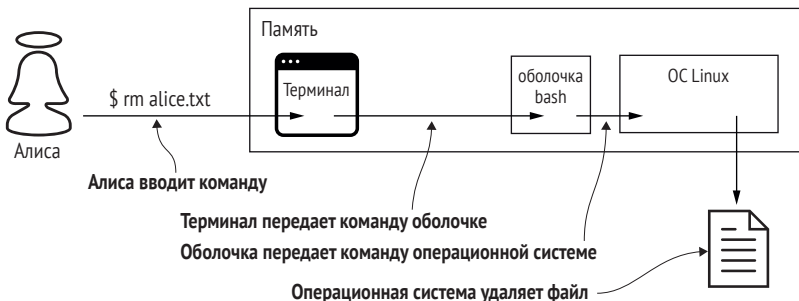
Рис. 12.1 Командная оболочка bash принимает команды, которые Алиса вводит в терминале, и передает их операционной системе
