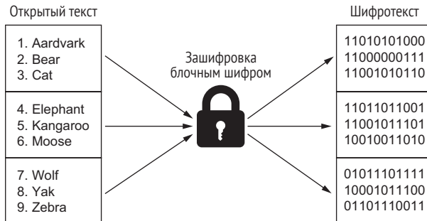
Рис. 4.4 Если блочному шифру подать на вход N блоков открытого текста, то на выходе получим N блоков шифротекста
