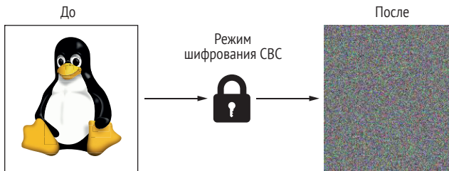
Рис. 4.6 При использовании режима CBC структура открытого текста не воспроизводится в структуре шифротекста
