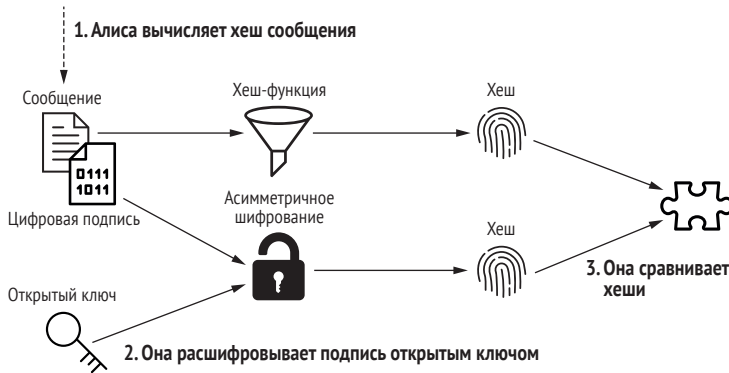
Рис. 5.3 Алиса получает сообщение от Боба, расшифровывает ЭЦП открытым ключом отправителя и сравнивает хеши. В этом и заключается проверка подписи
