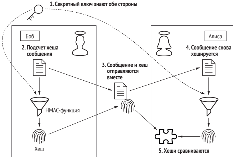
Рис. 3.3 Алиса удостоверяется, что данные присланы Бобом, с помощью общего ключа и HMAC-функции
