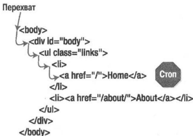
Рис. 6.2. Результат наступления события перехватывается в первом элементе разметки <a>
