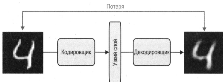
Рис. 2.11. Во время тренировки автокодировщика признак и метка одинаковы, а потерей является ошибка восстановления. Это позволяет автокодировщику добиваться нелинейного уменьшения размерности
