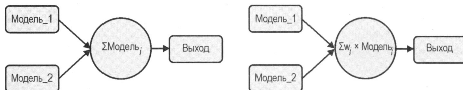
Рис. 3.14. Простейшая форма модельного усреднения усредняет результаты двух или более разных моделей машинного обучения. Среднее значение можно заменить средневзвешенным, где вес может основываться на относительной точности моделей
