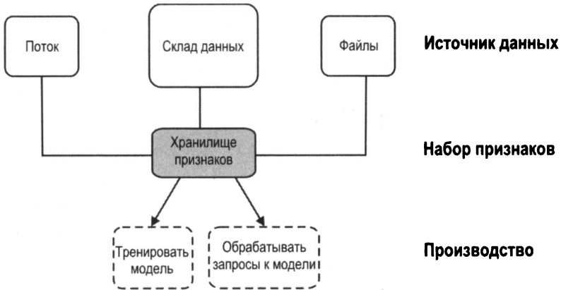
Рис. 6.16. Хранилище признаков обеспечивает согласованность конвейеров генерирования признаков между тренировкой модели и обработкой запросов. См. также https://docs.feast.dev/
