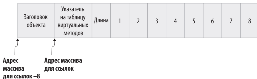
Рис. 2.3. Фактическое размещение массива в памяти
