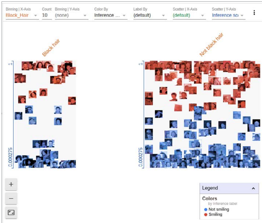
Рис. 5.3. Редактор точек данных инструмента What-If позволяет фильтровать и визуализировать данные в соответствии с учетом аннотаций в датасете и меток, присвоенных классификатором
