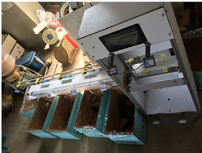
Рис. 15.14. Устройство для сортировки огурцов Мамото Койке (с сайта https://oreil.ly/0c50p )
