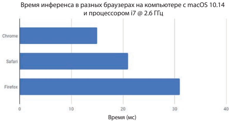
Рис. 10.20. Время инференса в разных браузерах на компьютере с macOS 10.14 и процессором i7 @ 2.6 ГГц
