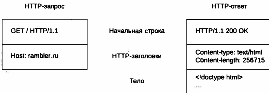
Рис. 2.5. Структура HTTP-сообщений запроса и ответа
