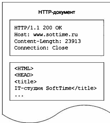
Рис. 18.7. HTTP-документ состоит из HTTP-заголовков и тела документа
