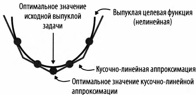
Рис. 10.5. Аппроксимация выпуклой функции кусочно-линейными функциями
