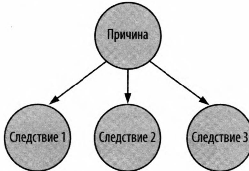
Рис. 11.1. Байесовская сеть, отображающая три следствия с одной общей причиной
