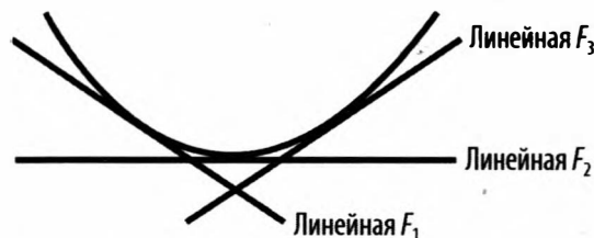
Рис. 3.8. Выпуклая функция равна максимуму всех своих касательных
