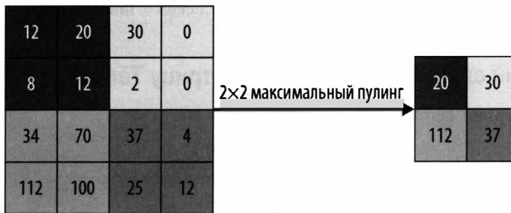
Рис. 5.5. Максимальный пулинг (источник изображения: https://oreil.ly/y9x9P )
