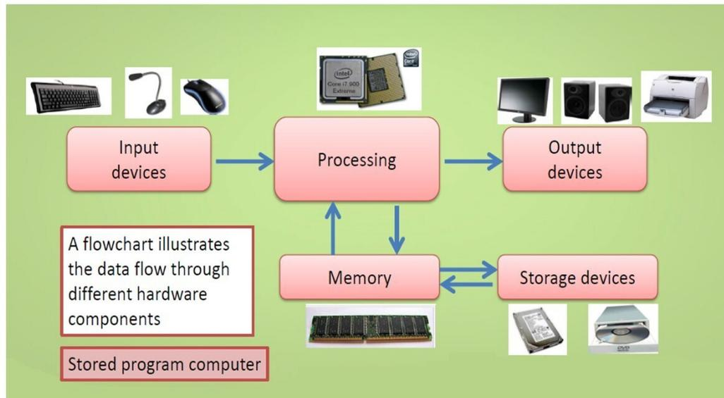
Диаграмма здесь иллюстрирует поток данных с помощью различных аппаратных компонентов.
