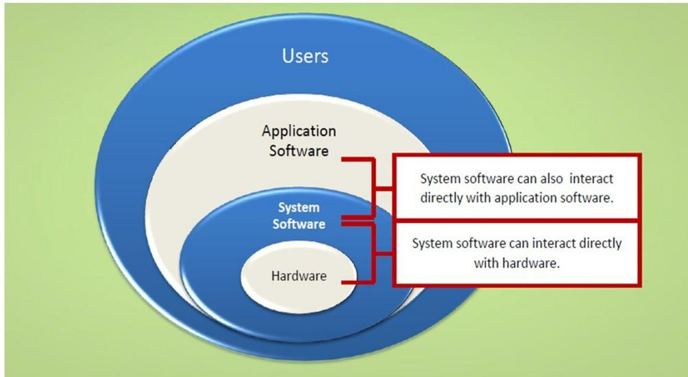
На схеме видно, что системное программное обеспечение может с одной стороны взаимодействовать с оборудованием и с другой стороны взаимодействует с прикладным программным обеспечением.
