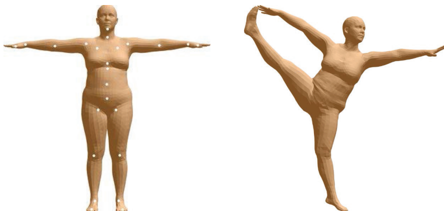
Рис. 8.2 ❖ Первоначальная переходная форма (слева) и деформированная полигональная сетка, сгенерированная с помощью техники линейного-переходного кожного покрова (справа)
