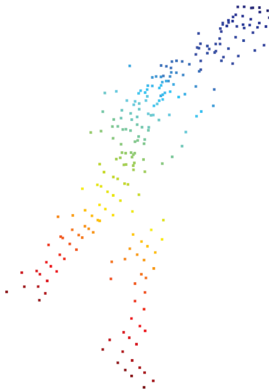
Рис. 3.1 ❖ Пример трехмерного облака точек на выходе камеры глубины; обратите внимание на относительно низкую плотность точек
