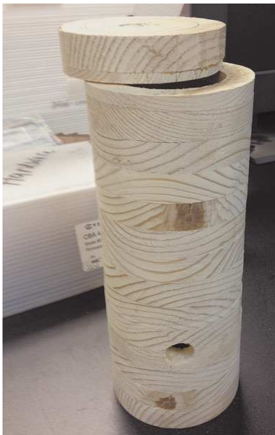
Рис. 9.16. Обрезаем и просверливаем цилиндр
