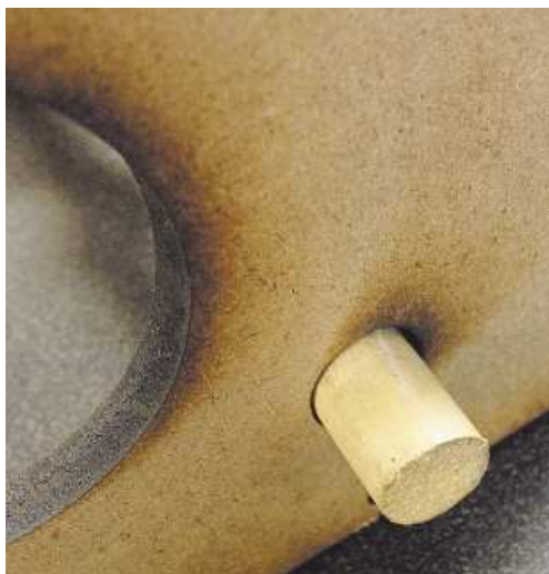
Рис. 13.13. Стержень выступает с противоположной стороны каркаса
