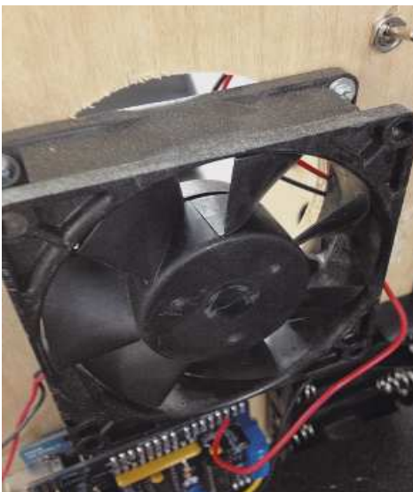
Рис. 13.16. Прикрепите кулер к задней панели корпуса
