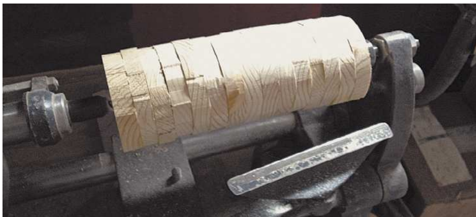
Рис. 9.14. Размещаем склеенную стопку на токарном станке
