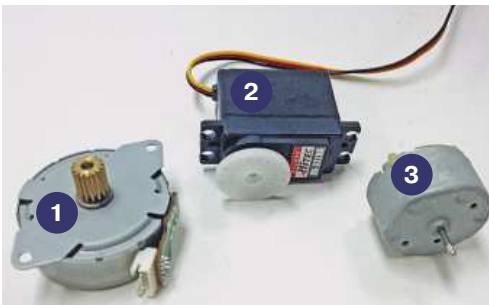
Рис. 1.10. Шаговые двигатели, сервоприводы и электродвигатели постоянного тока — основные виды электродвигателей в электронике:
