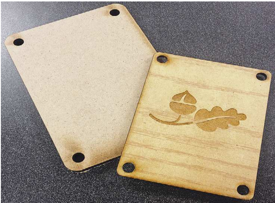
Рис. 4.18. Я использовал лазер для вырезания боковин
