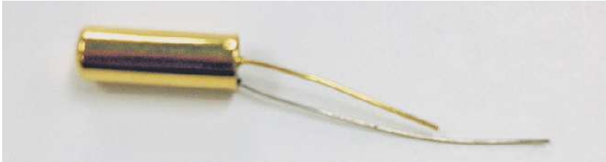
Рис. 6.12. Датчик звука, извлеченный из сломанной игрушки
