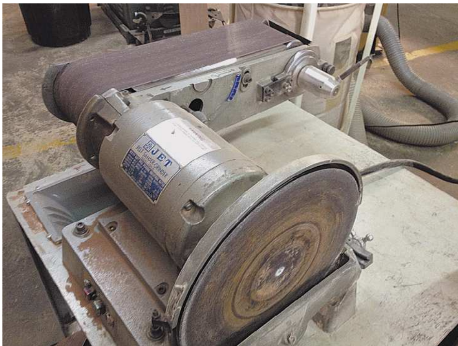
Рис. 8.21. Сочетание дискового и ленточного шлифовальных станков позволяет шлифовать древесину двумя различными способами
