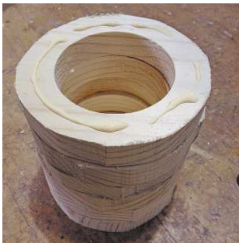
Рис. 9.12. Склейте кольца вместе, чтобы получился цилиндр
