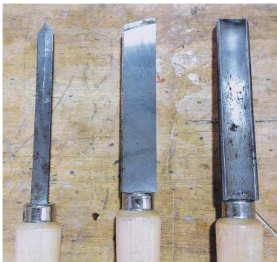
Рис. 9.26. Используйте деревообрабатывающие стамески с длинными рукоятками для врезки в крутящуюся древесину
