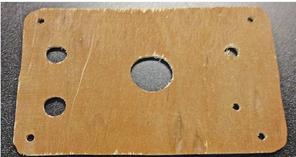
Рис. 10.13. Верхняя панель перед монтажом
