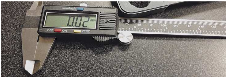
Рис. 8.7. Цифровой штангенциркуль отображает измерения на жидкокристаллическом экране — необязательно угадывать размер!
