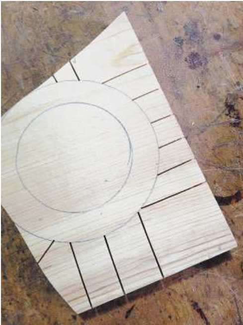
Рис. 9.10. Вырезаем круги с помощью ленточной пилы
