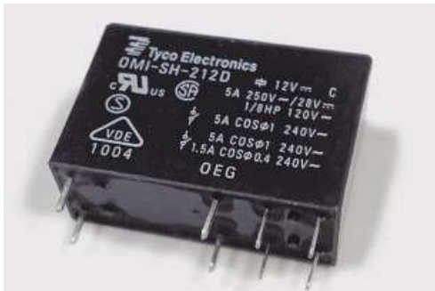
Рис. 12.2. Реле как билет-допуск к управлению высоким напряжением
