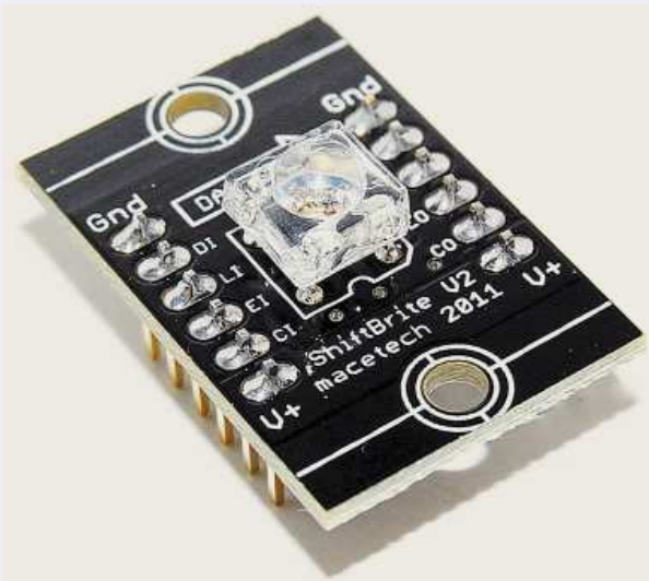
Рис. 6.15. Плата «ShiftBrite» обслуживает один RGB-светодиод
