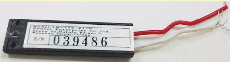
Рис. 2.9. Лазерный излучатель 0,8 мВт с питанием от 3 В
