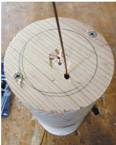
Рис. 9.21. После того как двигатель установлен, закрутите верхнюю крышку
