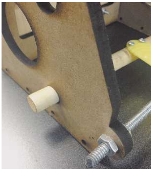
Рис. 13.11. Резьбовые стержни обеспечивают надежность каркаса
