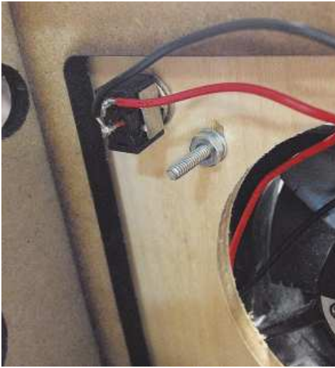
Рис. 13.15. Тумблер включает и выключает машинку для пузырей
