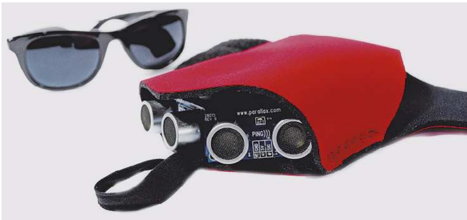
Рис. 9.1. «Tacit» имеет вид перчатки, которая сжимается при обнаружении препятствия
