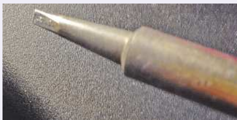
Рис. 3.5. Надо погружать кончик паяльника в олово до, во время и после пайки
