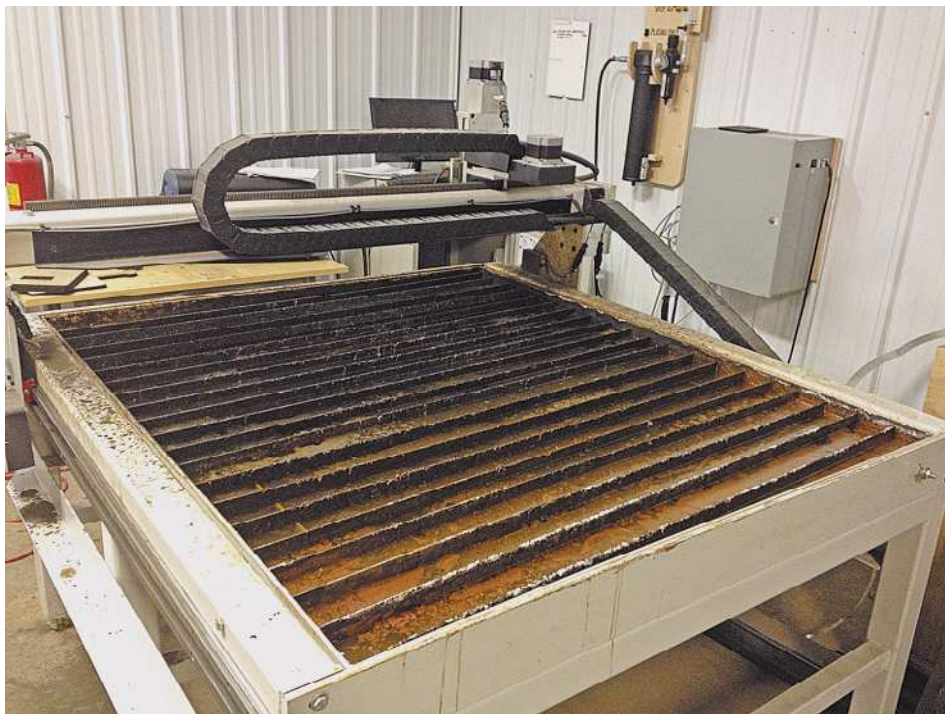
Рис. 8.29. Плазменный резак использует струю раскаленной добела плазмы, чтобы прорезать металл
