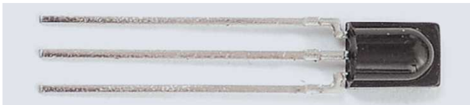
Рис. 12.10. Датчик инфракрасного излучения, подобный этому, улавливает сигналы с пульсацией 38 кГц, но игнорирует другое инфракрасное излучение
