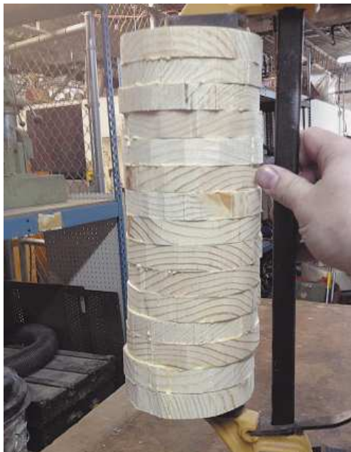
Рис. 9.13. Стопке колец необязательно быть совершенной! Токарный станок обработает ее
