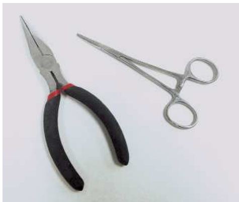
Рис. 3.10. Нужно взять и удержать мелкую деталь? Острогубцы и пинцеты — это то, что вам нужно!
