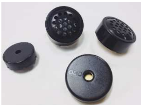
Рис. 1.12. Хотите создать звук с помощью Arduino? Подключите один из этих пьезоэлементов
