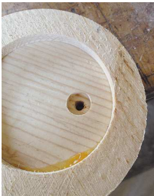
Рис. 9.17. Сверлим отверстие для провода с углублением для втулки сервопривода
