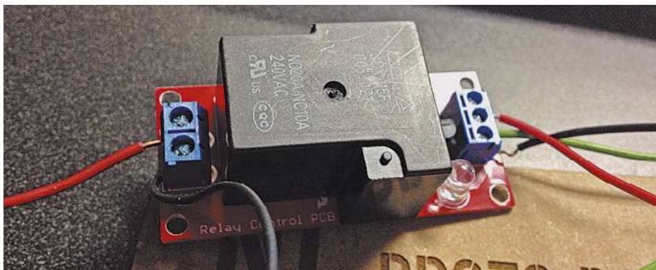
Рис. 12.5. Плата управления реле «Beefcake» от компании SparkFun может коммутировать напряжение до 220 В/20 А
