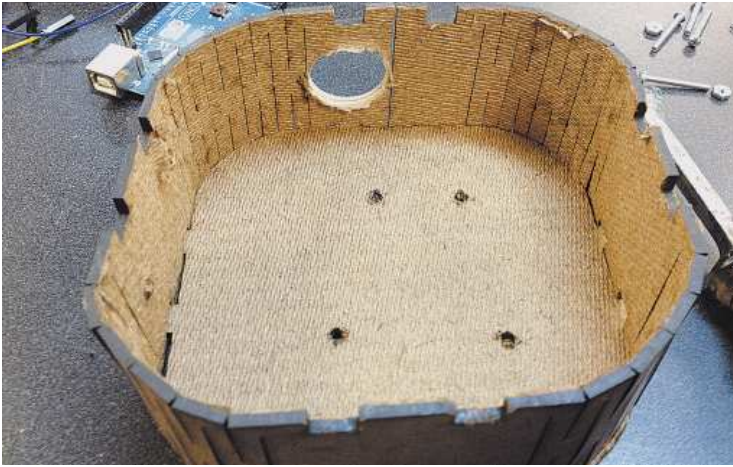
Рис. 6.16. Проект корпуса использует вид резки, который называется «керф-бэндинг» («надрезать и согнуть»), позволяющей древесине сгибаться по кругу для формирования стенок
