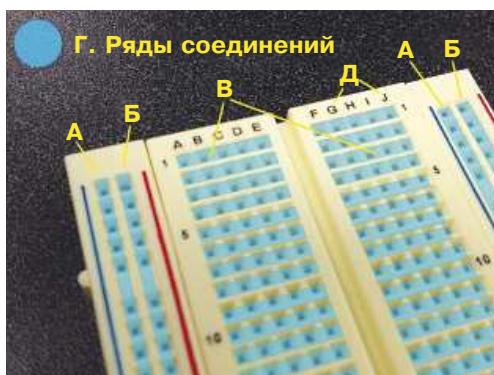
Рис. 2.2. Устройство стандартной макетной платы
