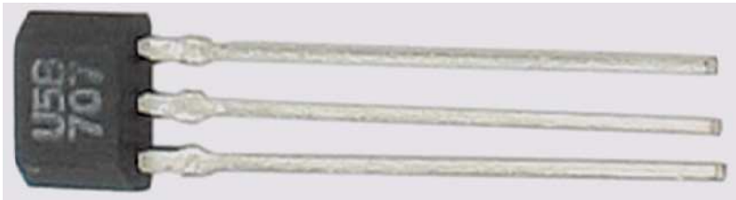
Рис. 6.9. В датчике Холла возникает разность потенциалов, когда рядом находится магнитное поле
