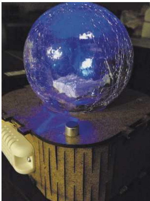
Рис. 6.14. Датчик температуры и влажности воздуха (белый пластиковый модуль) и датчик звука (маленькая кнопка в середине изображения) помогают контролировать цвет лампы
