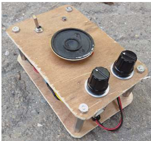
Рис. 10.9. Проект звукового генератора с Arduino для создания сумасшедших звуков
