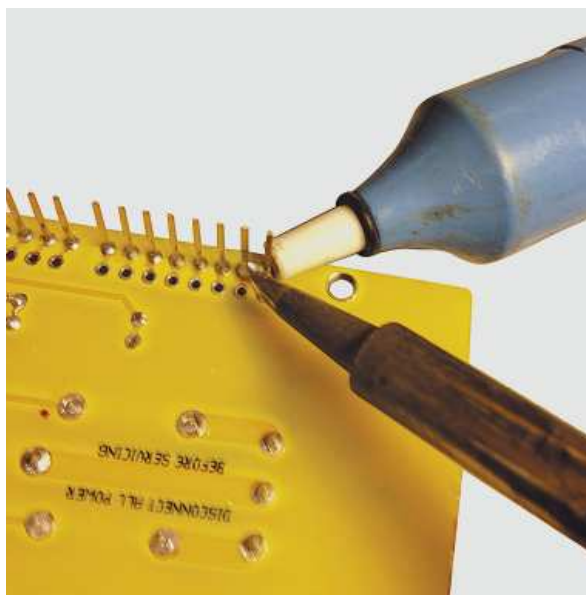
Рис. 3.21. Нагрейте неудачную пайку и удалите расплавленный металл!
