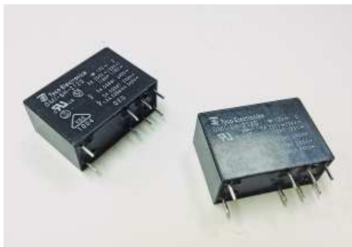
Рис. 1.14. Реле — переключатели, управляемые с помощью Arduino, которые могут запускать схемы по команде
