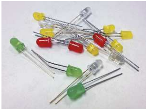
Рис. 1.5. Светодиоды — лампочки в мире электроники
