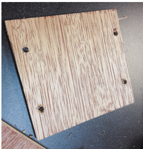
Рис. 11.16. Боковая панель готова к монтажу
