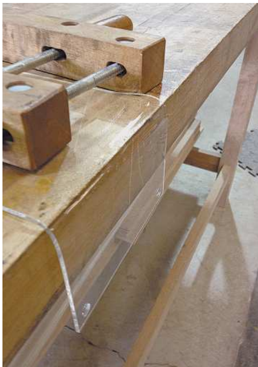
Рис. 4.17. Как только оргстекло нагревается, оно начинает гнуться
