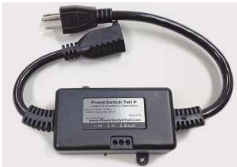
Рис. 12.3. Шнур питания с реле-переключателем в сущности представляет собой короткий провод со встроенной релейной платой
