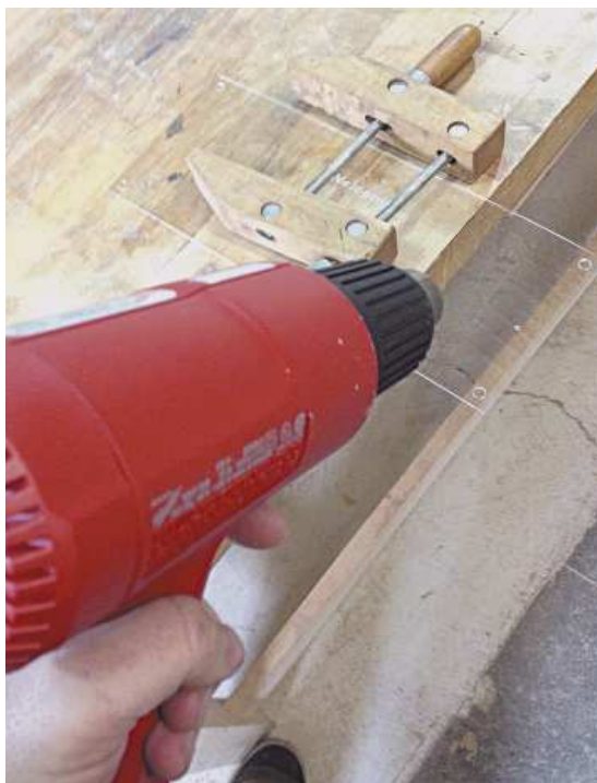
Рис. 4.16. Тепловая пушка размягчает оргстекло
