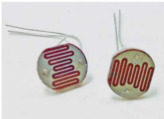
Рис. 1.18. Датчики передают Arduino информацию о степени освещенности
