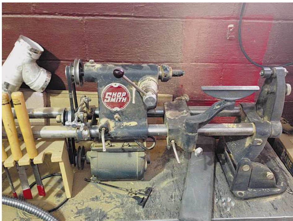
Рис. 8.20. Токарный станок вращает деревянную заготовку, помогая вам обрабатывать ее стамесками
