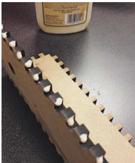
Рис. 2.17. Добавьте капельку клея на каждый шип, чтобы скрепить детали
