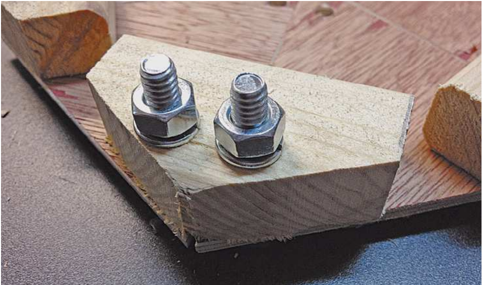
Рис. 11.11. Скрепленные бруски удерживают треугольные элементы, из которых сложены крышка и дно конструкции
