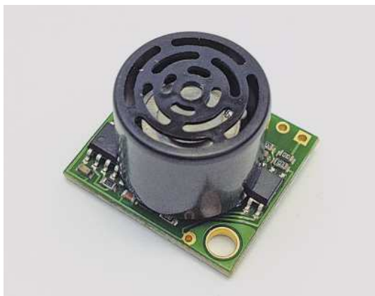
Рис. 1.19. Ультразвуковой датчик работает как радар
