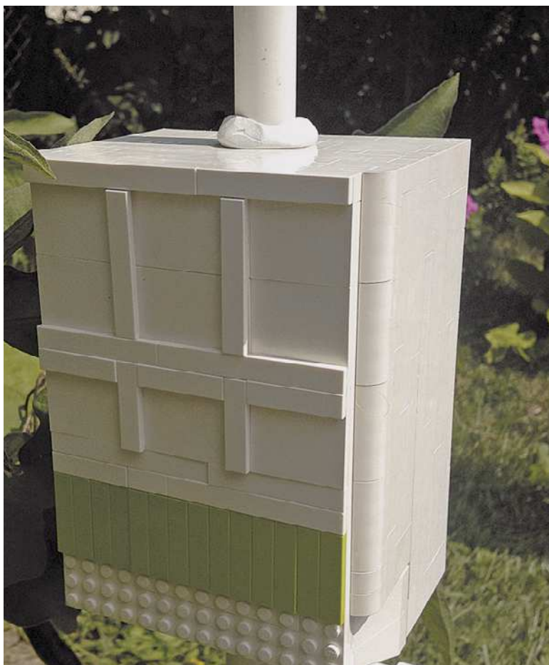
Рис. 7.19. Смажьте зазоры сугру, чтобы вода не попала в корпус
