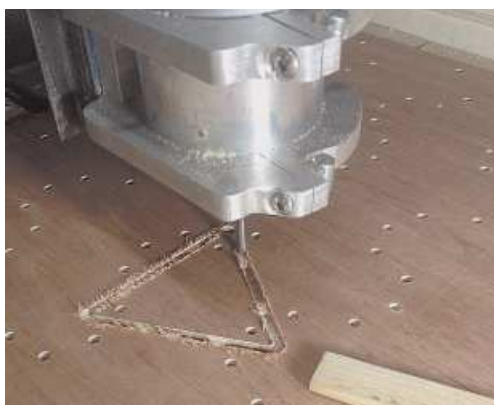
Рис. 11.9. Фрезерный мини-станок с ЧПУ вырезает формы, которые понадобятся для этого проекта
