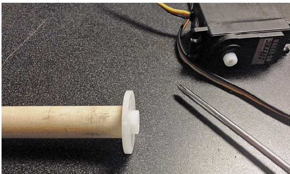
Рис. 13.12. Прикрепите сервонасадку с одного конца стержня
