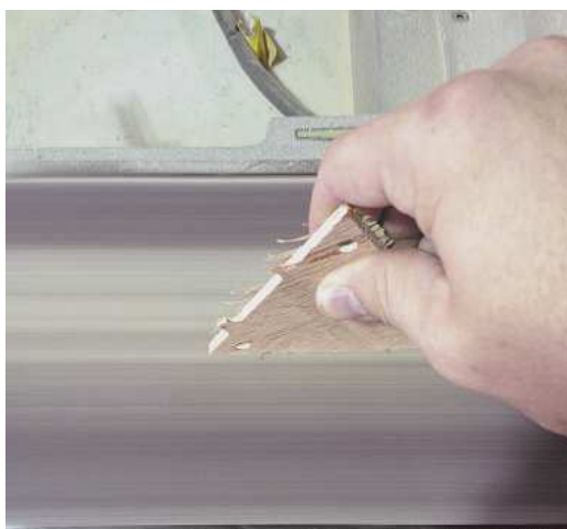
Рис. 11.10. Уберите неровности на шлифовальном станке
