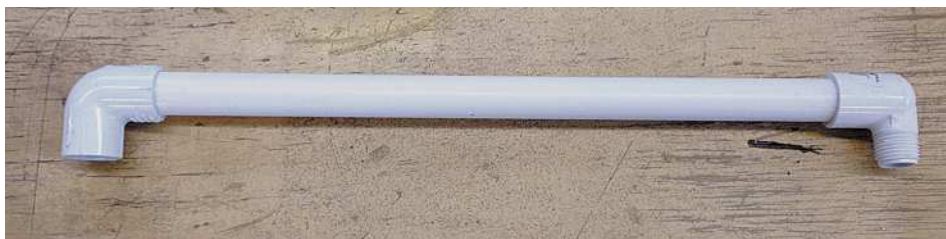
Рис. 7.13. Прикрепление угловых отводов к каждому концу трубы длиной 35 см
