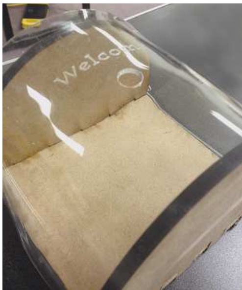
Рис. 4.14. Наружный корпус сделан из оргстекла на деревянном основании
