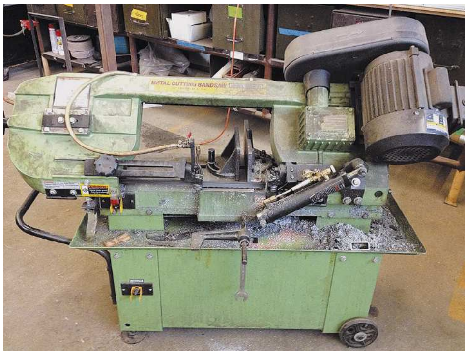
Рис. 8.30. Металлорежущий ленточнопильный станок — самый подходящий для резки тонких кусков металла
