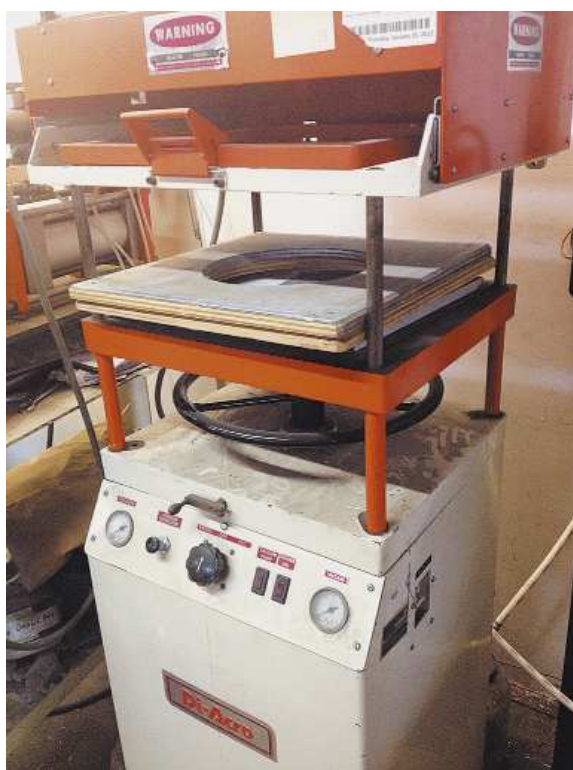
Рис. 8.26. Вакуумный формователь сначала нагревает пластик, а затем использует вакуум, чтобы материал принял форму копируемого объекта
