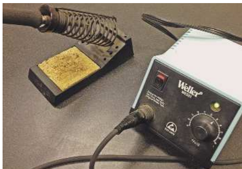
Рис. 3.4. Относительно дорогой «Weller WES51» обладает большими возможностями, чем паяльник-ручка
