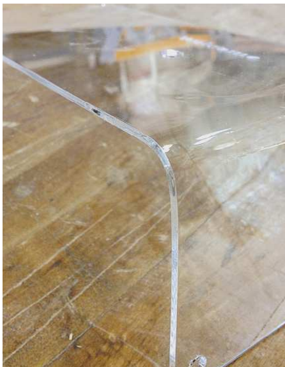
Рис. 4.15. Сгибание оргстекла — легкий процесс, который дает прекрасный результат!
