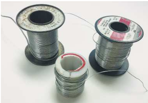
Рис. 3.6. Припой отличается составом сплава и размерами. Убедитесь, что вы выбираете тот, который лучше всего подходит для вашего проекта
