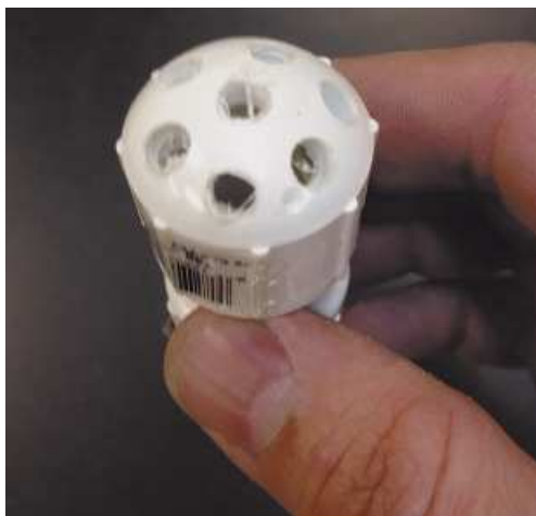
Рис. 7.14. Просверлите отверстия в заглушке, чтобы сделать разбрызгиватель
