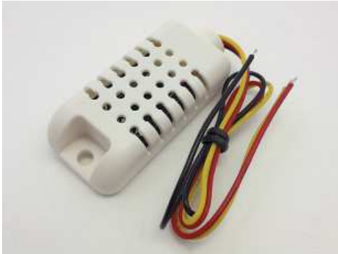
Рис. 1.16. Датчики температуры передают Arduino данные о состоянии окружающей среды
