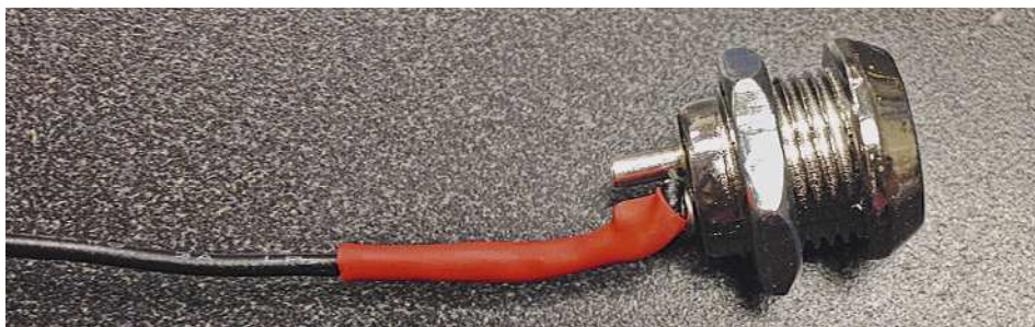
Рис. 2.14. Закрепите провод с помощью термоусаживаемой трубки
