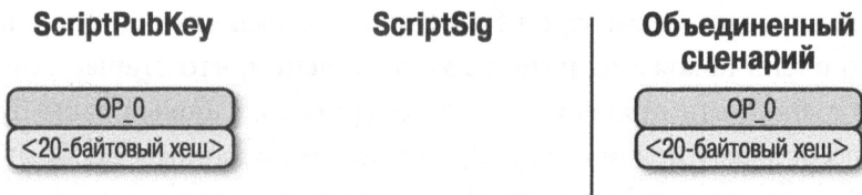
Рис. 13.3. Поля ScriptPubKey и ScriptSig для оплаты по хешу открытого ключа с отдельным заверением (p2wpkh)
