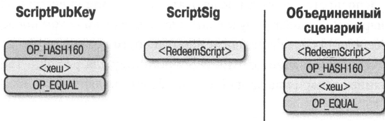
Рис. 13.11. Поле ScriptPubKey в p2sh-p2wprkh оказывается таким же, как и обычное поле ScriptPubKey в p2sh
